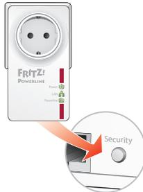
3. Für den nächsten Schritt haben Sie 2 Minuten Zeit: Drücken Sie am neuen Powerline-Adapter den Taster für sichere Powerline-Verbindungen. Der Taster ist mit „Security“, „Powerline“ oder ähnlich beschriftet.
