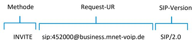
Der Message Header beinhaltet u.a. Angaben in Form von sogenannten Header-Feldern (FROM, TO etc.). Der Message Body ist eine optionale Angabe. Er wird beispielsweise bei einer INVITE-Nachricht benötigt, da er Daten zur Aushandlung des Medienstroms (RTP) enthält.
