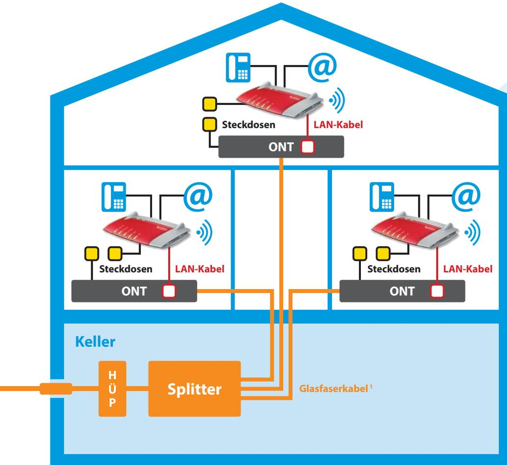
Das Glasfaserkabel von den Stadtwerken und M-net endet am Hausübergabepunkt, welcher sich i. d. R. im Keller des Gebäudes befindet. Bei vorhandener Glasfaser-Hausverkabelung<sup>1</sup> installiert unser Servicetechniker das Glasfaser-Abschlussgerät (ONT) und die FRITZ!Box an einer Anschlussdose<sup>1</sup> in Ihren Wohnräumen. Bitte stellen Sie sicher, dass am Tag der Inbetriebnahme zwei freie 230-V-Steckdosen in Reichweite der Geräte zur Verfügung stehen.
