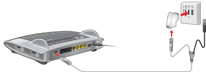
Anschluss mit DSL-/Telefonkabel und DSL-Adapter
