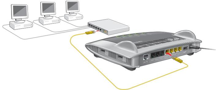
1. Stecken Sie das mitgelieferte Netzwerkkabel in den Uplink-Port des Netzwerk-Hubs oder Netzwerk-Switches.
