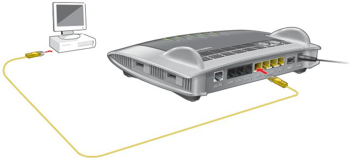
Anschluss eines Computers mit einem Netzwerkkabel
