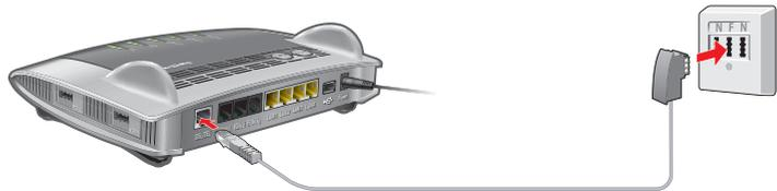
Anschluss mit DSL-Kabel
